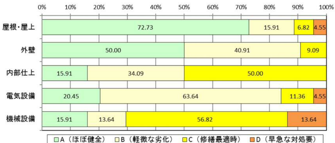
図一分類別の劣化状況 (A~D)
