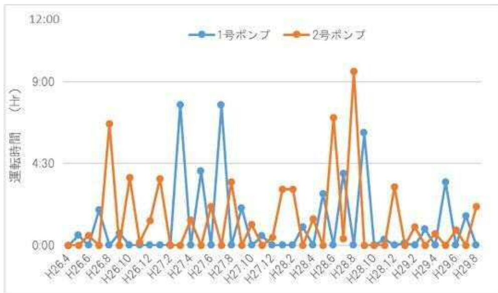
図2.8.2 北條雨水ポンプ場 主ポンプ稼働状況
