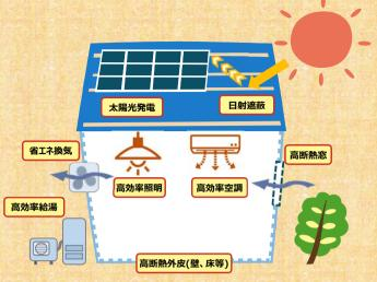
ZEHは住宅の高断熱化と省エネルギー設備機器により消費エネルギーを減らしつつ、太陽光発電等によりエネルギーをつくることで、住宅のエネルギー収支をゼロとすることを目指した住宅です。
